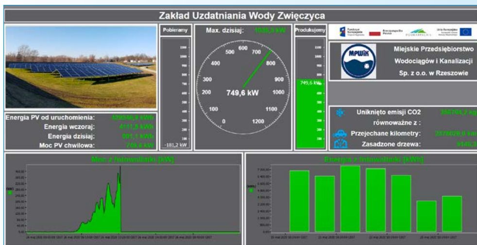
Wizualizacja i opis parametrów pracy instalacji fotowoltaicznej w Zakładzie Uzdatniania Wody
